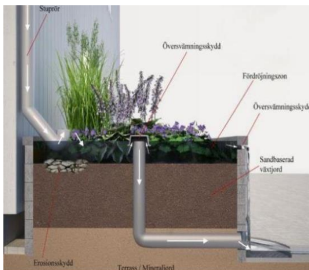
Figur 5. Principskiss över växtbäddskonstruktion med stuprörsanslutning och bräddavlopp.
